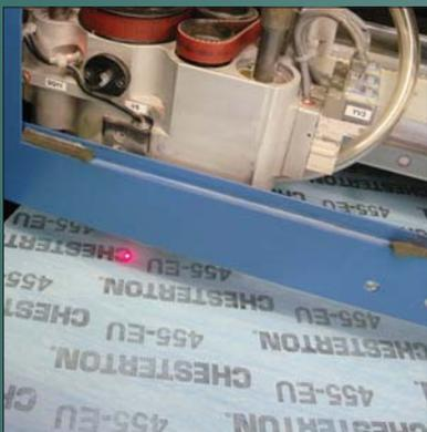
*Chesterton® Dichtungszentren können kurzfristig formgeschnittene Flachdichtungen liefern. Wir setzen moderne CNC-gesteuerte Schneidmaschinen ein, um Standard- und kundenspezifische Flachdichtungen rasch und exakt zu fertigen.*
